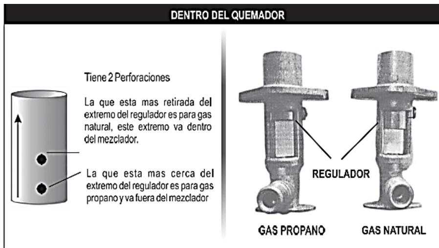
**NOTA:** El tornillo deberá instalarse según el gas que corresponda conforme a la imagen de la izquierda.
